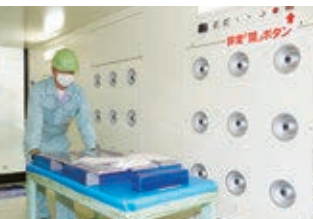
排水を24時間監視。万一異常がある時は自動的に遮断(左)。エアシャワーによって工場内外の汚染を防止(中)。ロッカールームにも集塵装置を設置(右)。地域の環境保全、従業員の安全衛生の徹底を図っています。
